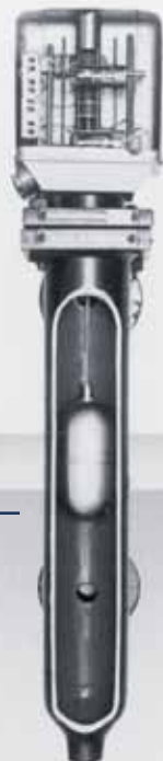
Bild 1: Schwimmer-Wasserstandsbegrenzer – das Prüfen der Sicherheitsschaltung und das tägliche Durchblas-Reinigen sind vorgeschrieben
