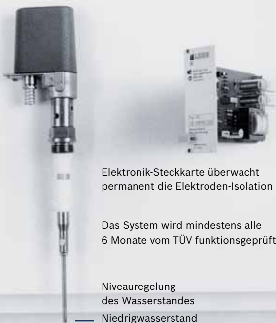
Bild 3: Zweikanalige Elektroden-Wasserstandseinrichtung – das System wird mindestens alle 6 Monate vom TÜV funktionsgeprüft
