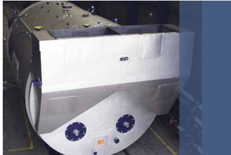
Aufgesetzter Economiser für uneingeschränkten Einzelbetrieb der Brenner
