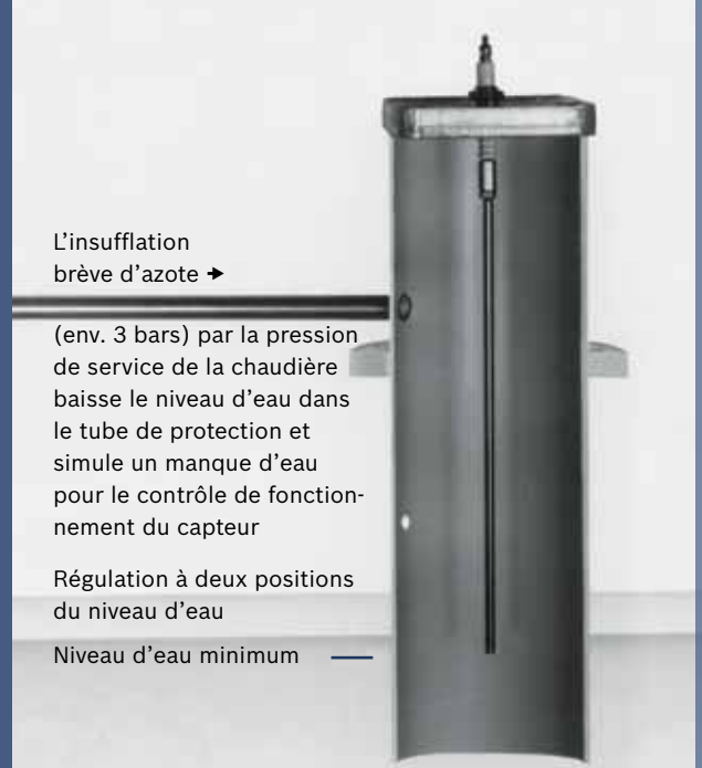
Illustration 2 : Électrode simple – contrôle quotidien obligatoire par insufflation d'azote
