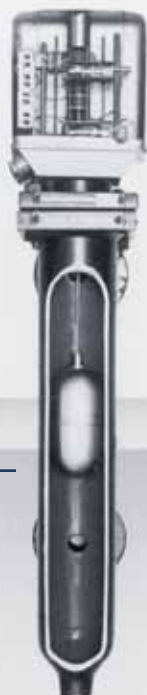
Illustration 1 : Limiteur de niveau d'eau avec flotteur – le contrôle de l'arrêt de sécurité et le nettoyage quotidien par insufflation sont prescrits
