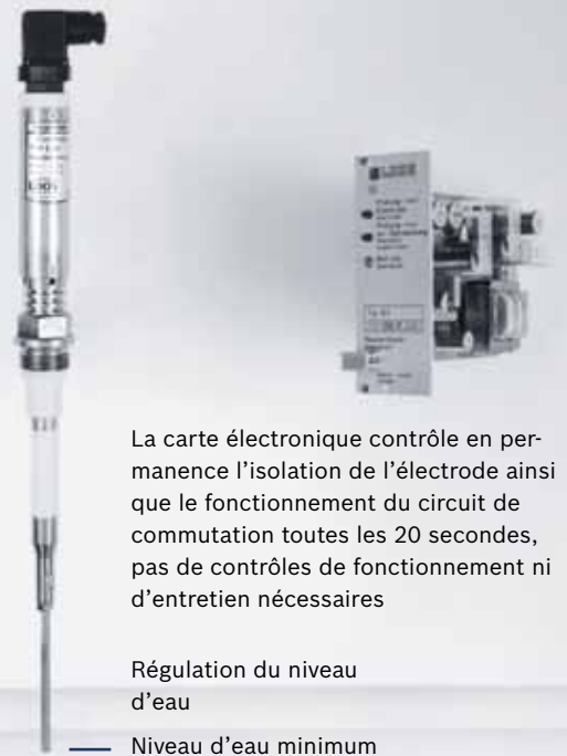
Illustration 4 : Dispositif de niveau d'eau avec électrode et système d'autocontrôle – pas d'entretien ni de contrôles de fonctionnement nécessaires
